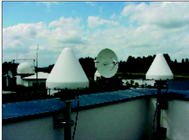
Abb. 1: Grundlage eines globalen geodätisch-geodynamischen Monitoringsystems ist die millimetergenaue Verknüpfung von GPS, des französischen DORIS-Systems, von Laserentfernungsmessung zu Satelliten und zum Mond und der Langbasisinterferometrie (VLBI). Sie wird in diesem Bild symbolisiert durch das VLBI-Teleskop, die Kuppel der Laserentfernungsmessanlage und die beiden GPS-Antennen (Fundamentalstation Wettzell).
