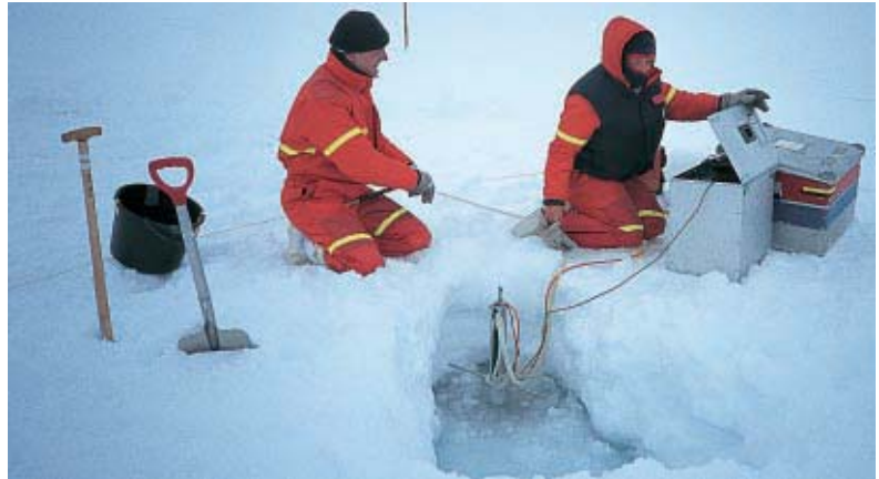
Mit Hilfe eines Laptop in einer beheizten Kiste starten Hannelore Witt und Volker Strass einen akustischen Strömungsmesser.
