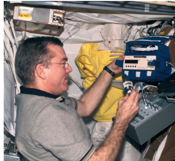
Astronaut James S. Voss baut die Apparatur des Experiments DOSMAP (Dosimetric Mapping) in das Human Research Facility (HRF)-Rack im amerikanischen Labor DESTINY ein
