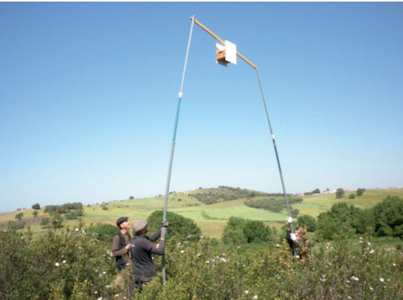
Abb. 12: Spektrale Geländemessungen zur Validierung von fernerkundlichen Bildanalysen.
