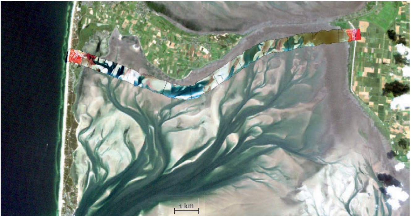
Abb. 21: Satellitenbild vom Wattenmeer mit geringer spektraler Auflösung (Landsat), und einem Streifen hyperspektraler Flugzeugbefliegungsdaten (AISA). Diese Abbildung zeigt exemplarisch die unterschiedliche räumliche Abdeckung lokaler Flugzeugdaten und regionaler Satellitendaten wie beispielsweise EnMAP-Daten, die weiträumige, die weiträumige Landschaften wie das Wattenmeer erfassen können.
