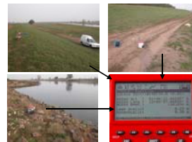
a) Aufnahme der Lagekoordinaten mittels GPS
