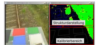
Abb. 6: Ergebnis einer Aufnahme mit Zeilenkameras (links) und gefilterte Darstellung mit clusterter Strukturdarstellung (rechts)
