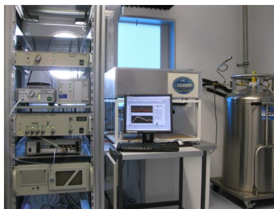
Abbildung 4 Das Mikrowellen-Radiometer SOMORA misst die vertikale Verteilung des Ozons über Payerne
