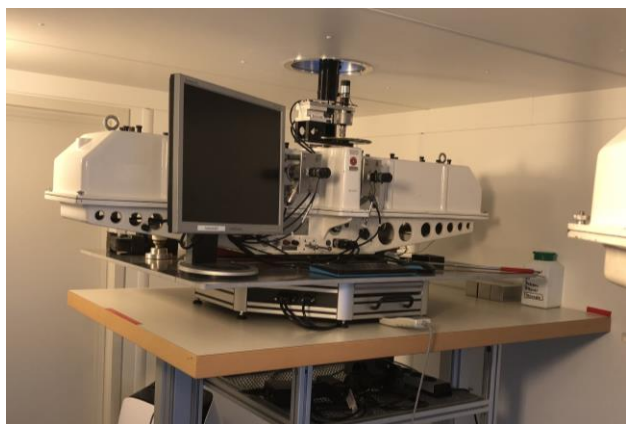
Abbildung 2 Spektrophotometer des Typs Dobson zur Messung der Sonneneinstrahlung in Ozonsäulen
