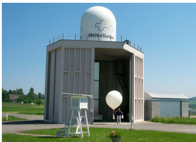
Abbildung 3 Start einer aerologischen Ballonsonde zur Messung des Ozonprofils und der meteorologischen Parameter
