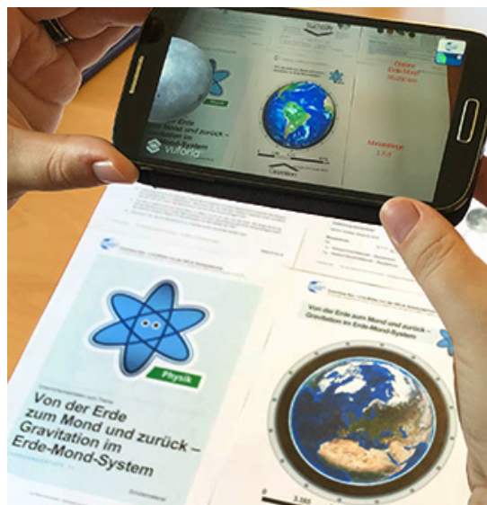
Abb. 4: Ansicht der AR-App „Erde-Mond-System“. Das Markerbild wird zur Erde, das Smartphone zum Mond. Informationen über Entfernungen zwischen den beiden Körpern und die Auswirkung dieser Entfernung können eingeblendet werden.
