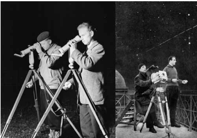
Abb. 3: Beginn der Satellitengeodäsie auf dem Telegrafenberg in Potsdam 1957: Bahnvermessung von Sputnik-2, links mit Zenitfernrohr und Stoppuhr (Foto: V. Kroitzsch), rechts auf dem Dach des damaligen Astrophysikalischen Observatoriums mit einer Kamera (Montage mit einer fotografierten Satellitenspur, Quelle unbekannt)
