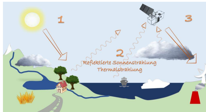
Abb. 5.2: PASSIVE Systeme werden im Bereich von Sichtbar bis Infrarot eingesetzt. In diesem Bereich des elektromagnetischen Spektrums ist man auf einen wolkenfreien Himmel angewiesen. Die Sensoren erfassen die Strahlung, die von Objekten und ihrer Umgebung emittiert oder reflektiert wird. In der Regel ist dies die reflektierte Sonnenstrahlung. Ein Beispiel für die Verwendung von passiven Sensoren ist Sentinel-2.
