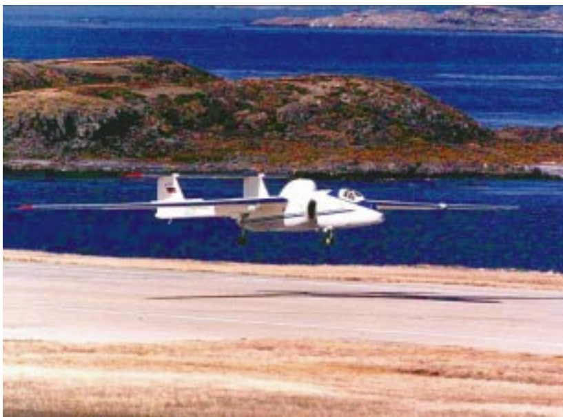
Abb. 1: Die GEOPHYSICA beim Anflug auf Ushuaia auf Feuerland. MIPAS-STR ist auf dem Rücken des Flugzeugs, hinter der Pilotenkabine, eingebaut.
