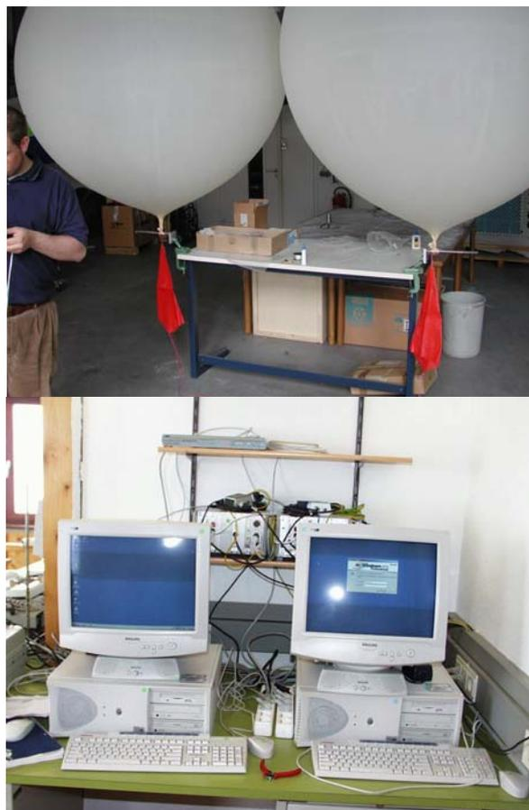
**Abbildung 8:** Duales Radiosondensystem zur Messung von Wasserdampf- und Temperaturprofilen bis >20 km Höhe.
