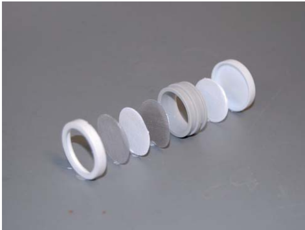
Abb. 5-2: Elemente des Fernsammlers, Fernsammler in der Halterung, 1€-Münze als Größenvergleich. Bild LUBW 2008
