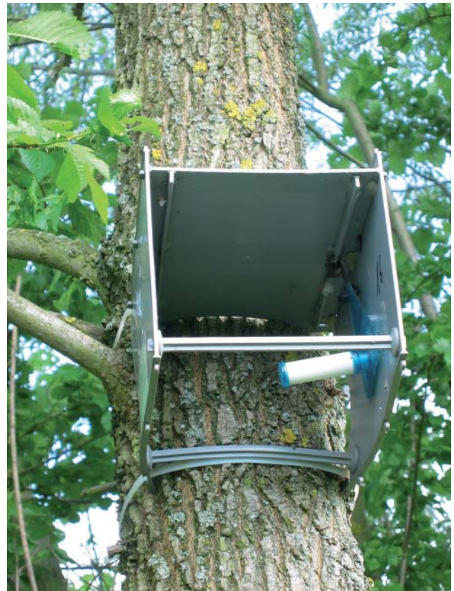
Abb. 5-1: Radiello Passivsammler im Einsatz. Bild: LUBW 2006
