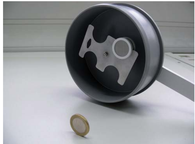
Abb. 5-2: Elemente des Fernsammlers, Fernsammler in der Halterung, 1€-Münze als Größenvergleich. Bild LUBW 2008
