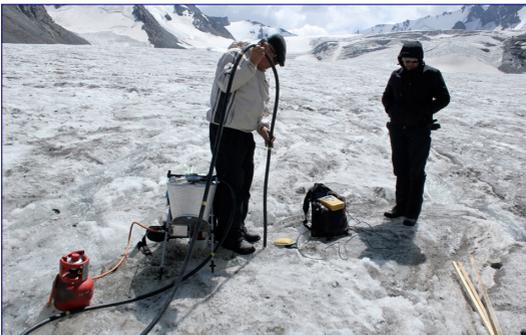
**Abb. 3.1-3:** Bohren eines 6 m tiefen Loches im Eis des Golumbingletschers in Zentralasien mit dem Heucke Eisbohrer zur Verankerung von Pegelstangen, mit welchen die Eisschmelze über das Jahr bestimmt wird (Foto: M. Hoelzle, Sommer 2012).
