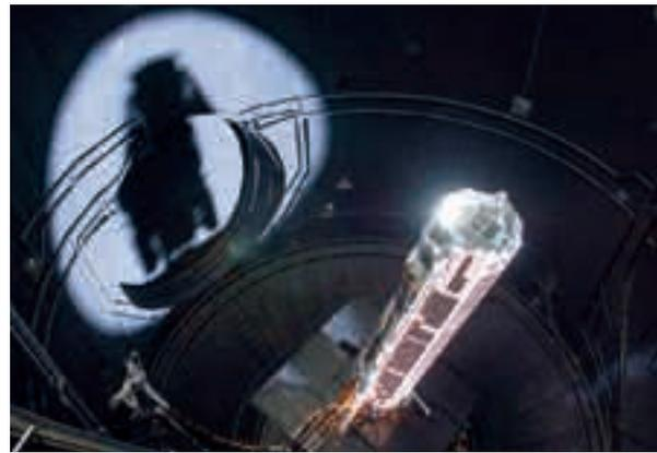
Bereit für den großen Sonnensimulator. Bei ESTEC/NL wird der GOCE-Satellit extremen Temperaturen ausgesetzt, um die Bedingungen im Weltall zu simulieren. ESA
