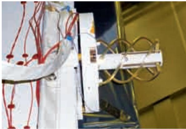
Helix-L-Band-Antenne des GPS-Empfängers, ESA
