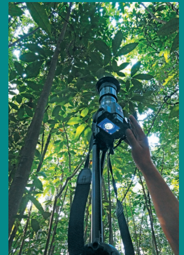
Mit einem speziellen Kamera-Objektiv fotografieren die Forscher die Baumkronen. So erfassen sie Dichte und Lichtdurchlässigkeit des Blätterdachs.
