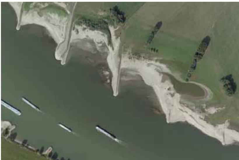
**Abb. 2:** Trocken gefallene, optimal erkennbare Bühnenfelder im September 2009
