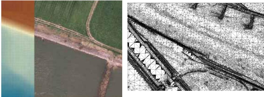
**Abb. 6:** Modelle A (links) und B2 (rechts). Das Modell A ist ein regelmäßiges 1m-Punktraster und kann auch als farbkodiertes „Grid“ dargestellt werden (linker Bildteil). Beim ausgedünnten TIN des Modells B2 sind deutlich „homogene“ Flächen (=wenige und große Dreiecke) und heterogene Strukturen (viele kleine Dreiecke) erkennbar.
