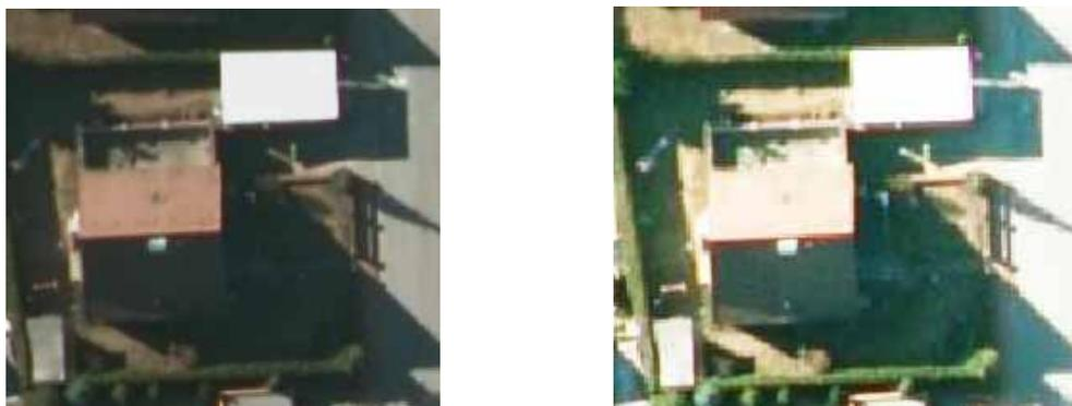
**Abb. 6:** Verbesserte Bildinterpretation aufgrund einer höheren Farbtiefe (16-bit Farbtiefe in beiden Bildern, rechtes Bild: nach optimaler Histogrammspreizung)
