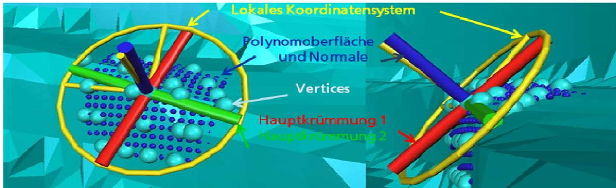
**Abb. 2:** Bestimmung von Hauptkrümmungen durch Approximation einer Polynomfläche an Eckpunkte des Netzes (Vertices): erste Hauptkrümmung (roter Zylinder), orthogonal die 2. Hauptkrümmung (grüner Zylinder)
